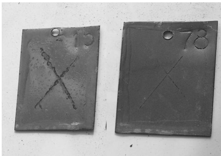
Рис.3. Образцы после испытаний через 1500 часов в соответствии с ГОСТ 9.401: а) – полимерное; б) никель-полимерное
