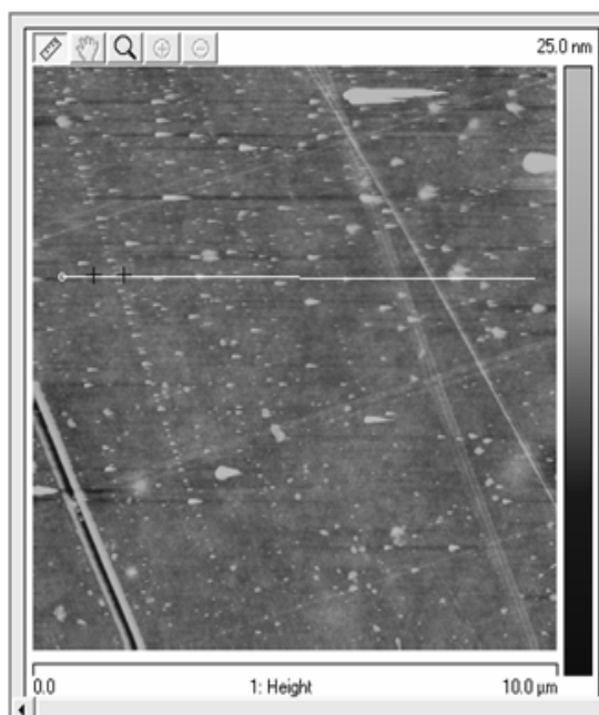
Рис.2 Микроструктура покрытия никель-полимер
